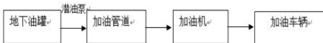
柴油加油工艺流程图
